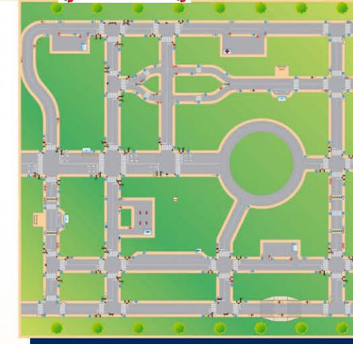
Детский автогородок площадью 1925 м<sup>2</sup> (55X35м). Стационарное оборудование, 6 светофорных объектов, управление светофорным оборудованием осуществляется при помощи единого беспроводного пульта АГ-2.
