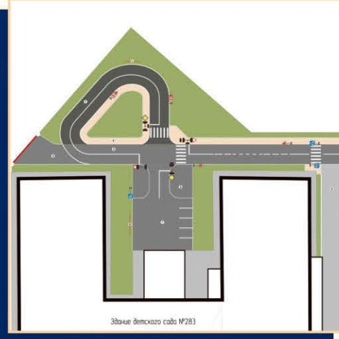
Автогородок, размещенный на прилегающей территории дошкольного образовательного учреждения. Стационарно-разборное оборудование, 1 светофорный объект, наземная кабельная разводка, управление светофорным оборудованием осуществляется при помощи пульта УП-1.
