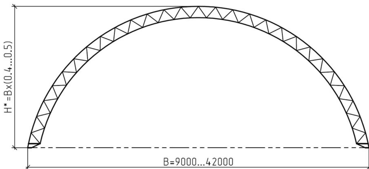
Ангар такого типа собирается из металлических полукруглых арок. Высота ангара строго зависит от ширины и составляет ее половину.
