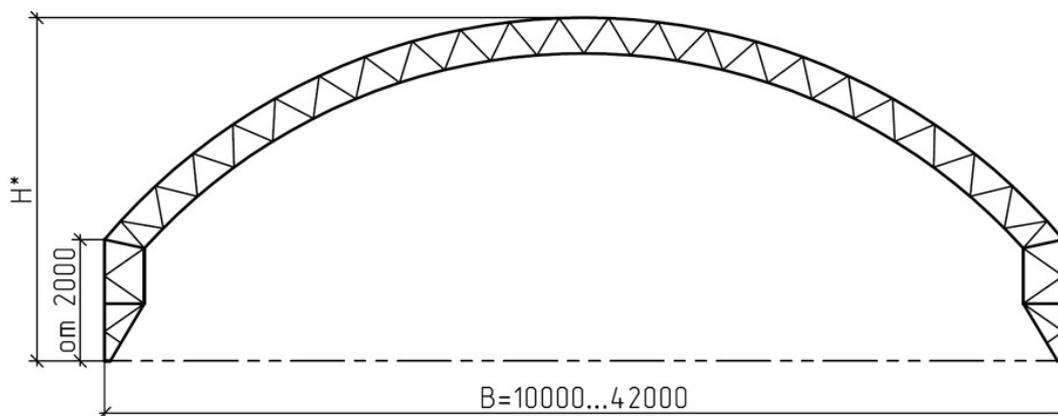
По сути тот же ангар типа "А", только для увеличения полезной площади, арочная крыша монтируется на вертикальные стены.
