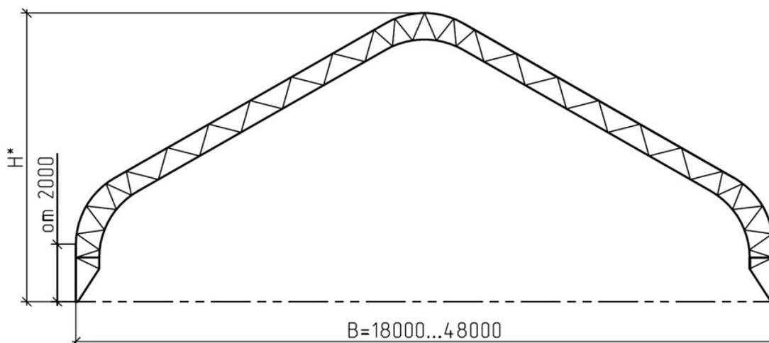
Ангар такого типа собирается из металлических полукруглых арок. Высота ангар строго зависит от ширины и составляет ее половину.
